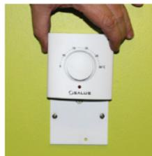
3. После установки передачи радиосигнала (стр. 7) установите переднюю панель на место и убедитесь, что она защелкнута правильно с обеих сторон. Услышите типичный звук "click" подтверждающий надежное защелпление.
